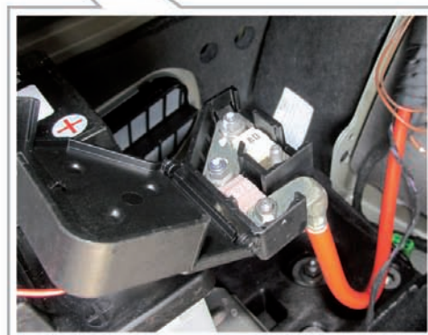
Предохранитель (200 А) на положительном полюсном выводе 12-вольтовой АКБ
