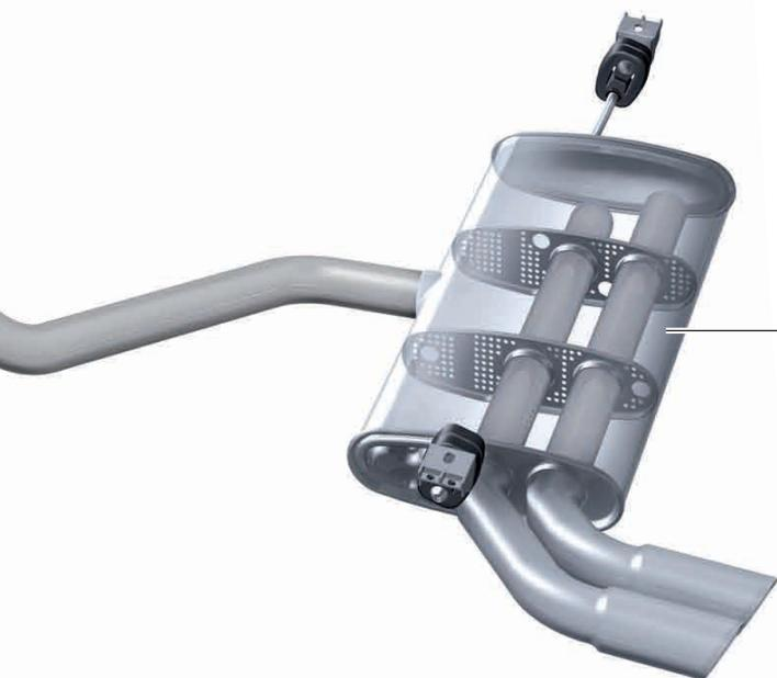
Задний глушитель резонансного типа
