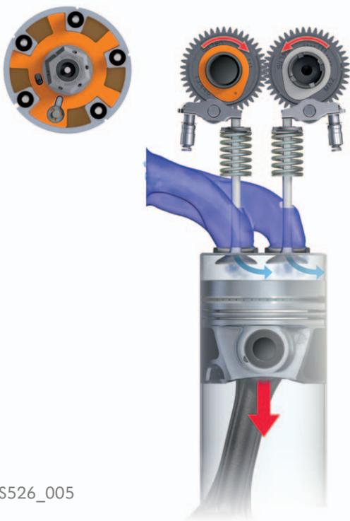
Оба клапана открываются одновременно. Всасываемый воздух попадает в цилиндр через оба клапана.
