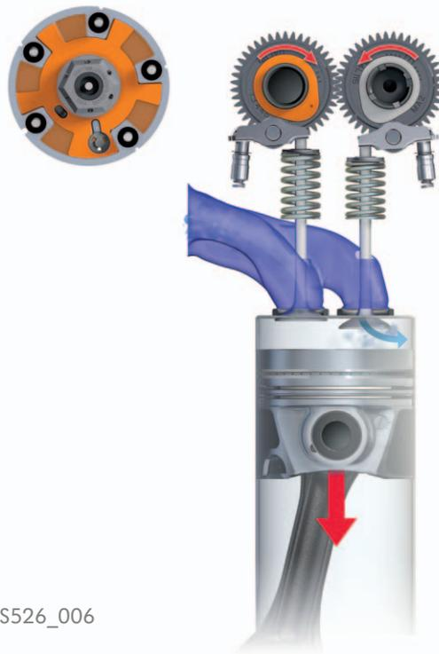
Открыт только впускной клапан, приводимый в действие нерегулируемым распредвалом. Весь поток всасываемого воздуха проходит через один впускной канал, чем достигается его завихрение.
