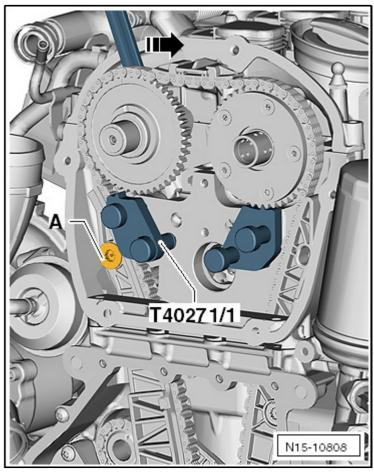
Проворачивать распредвал выпускных клапанов по часовой стрелке -1-, пока фиксатор распредвалов -Т40271/1- не вдавится в зубчатое зацепление звездочки.
