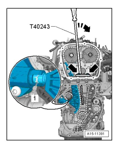
Застопорить натяжитель фиксатором -T40267-.
