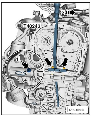
Застопорить натяжитель фиксатором -T40011-.
