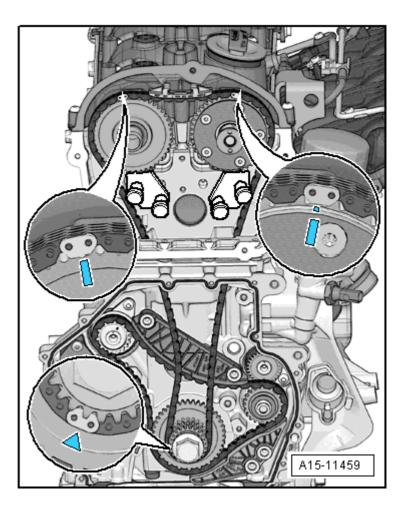
Установить успокоитель цепи привода распредвалов и затянуть болты -A-.
