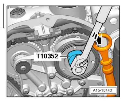
Вывернуть винты -стрелки- и снять опору коленвала.
