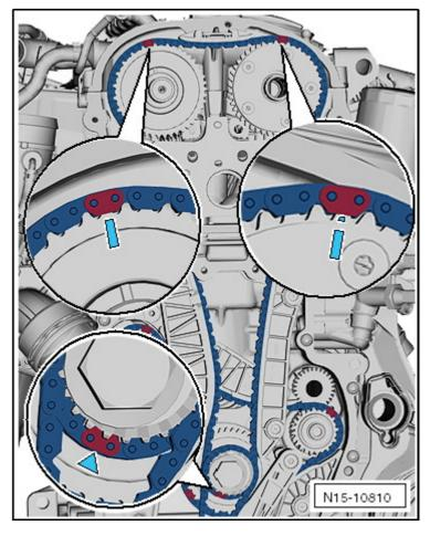
Установить цепь привода масляного насоса и натяжитель цепи. Затянуть болт -1- и удалить фиксатор -Т40011-.
