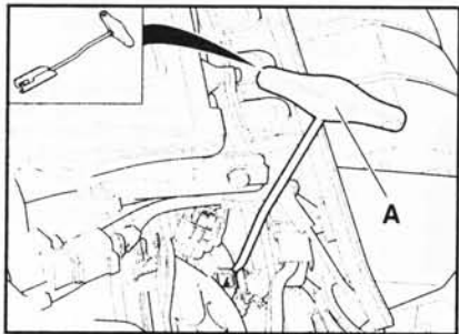
14.12 Разъединение разъема электропроводки свечи зажигания
