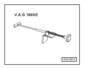
Brake pedal actuator V.A.G 1869/2
