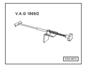
Brake pedal actuator V.A.G 1869/2
